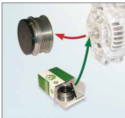
Slika 1: Preporuke: Zamjena remenice slobodnog hoda alternatora
