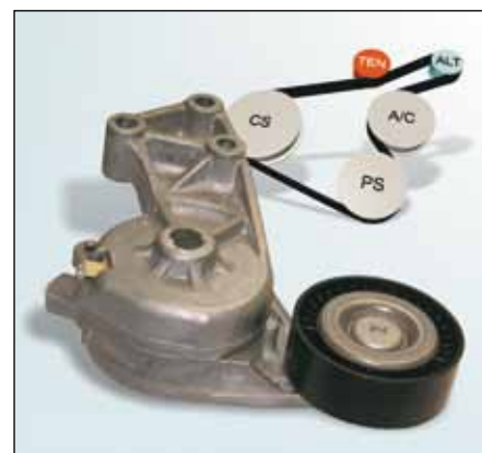
Slika 2: Jedinica za natezanje remena Kat. Br. 534 0132 30 namijenjena za motor 1,9 TDI s prikazom pravilnog kretanja remena
