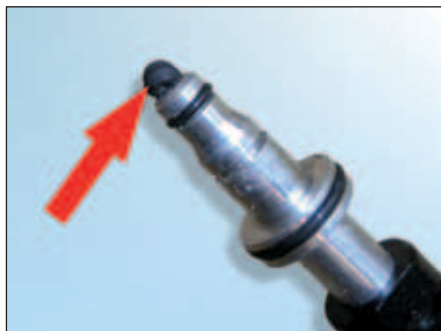
Slika br. 4: Ukoliko stari brtveni prsten nije uklonjen, bit će utisnut u CSC i doći će do začepljenja hidrauličkih vodova
