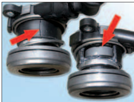
Slika br. 5: Hidraulični potisni ležaj uništen zbog nestručne montaže
