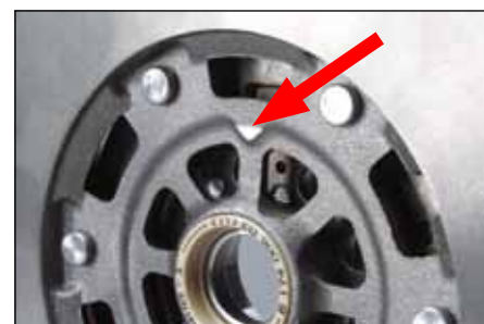
Slika 3: trokutna oznaka na zamašnjaku podijeljene mase (na strani mjenjača) koja označava položaj pozicijskog otvora (bušotine).
