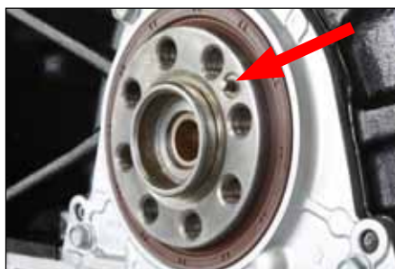
Slika 1: sigurnosni zatik za pozicioniranje na koljenastom vratilu
