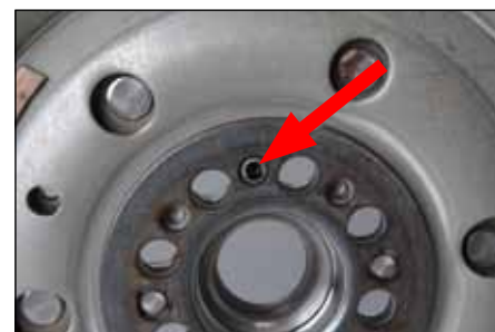
Slika 2: pozicijski otvor na zamašnjaku podijeljene mase (na strani motora)
