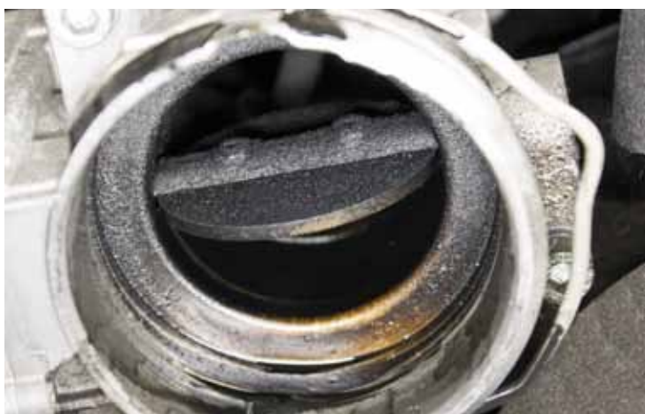
Slika 1: Mora biti otklonjena bilo kakva nečistoća iz kućišta prigušnog ventila
